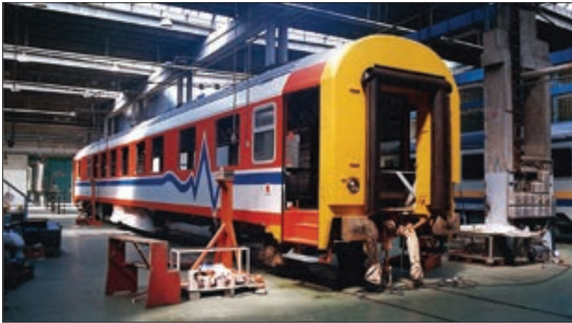
12. ábra: Az FMK 007 pályaszámú fényezett mérőkocsi végszerelése Dunakeszin (Fotó Lánzos Péter)
