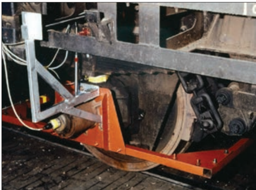
7. ábra: Vágánygeometria és járműfutás vizsgálat (fotó: Sleier Béla)
