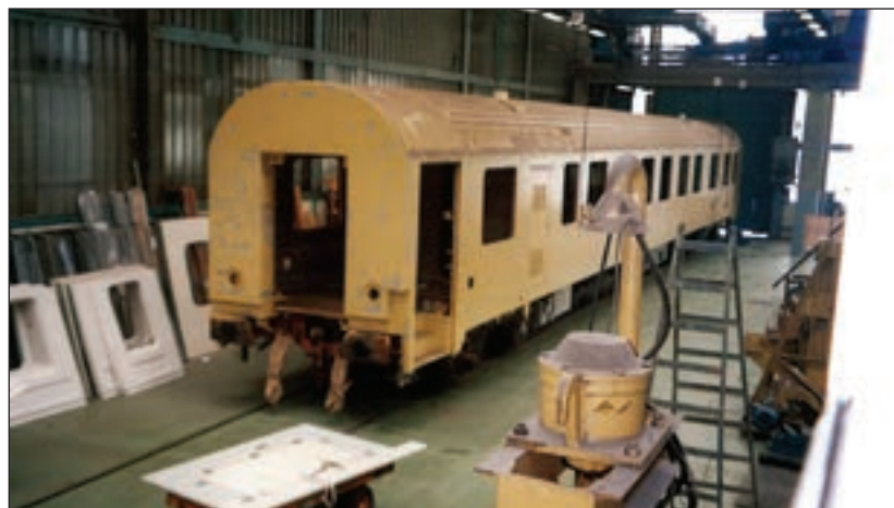
11. ábra: Az FMK 007 pályaszámú mérőkocsi építése Dunakeszin (Fotó Lánzos Péter)
