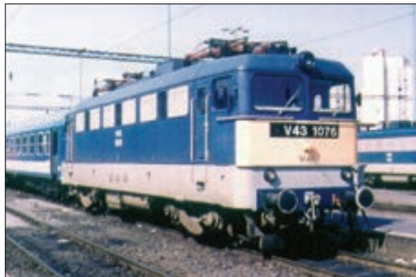
10. ábra: A V43-1076 pszú villamos mozdony tirisztoros szabályozásra átépítve 1968-ban
