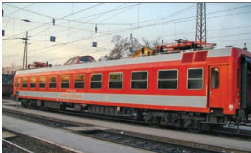
4. ábra: A MÁV felsővezetékvizsgáló mérőkocsija (Fotó: Kovács Károly)
