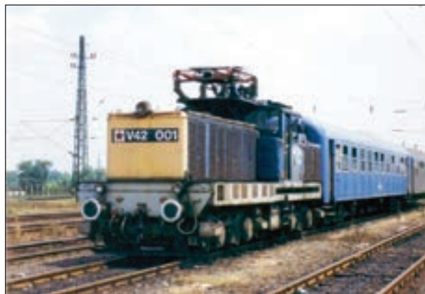
9. ábra: A Tirisztorosra átalakított V41-501 lett a V42 001
